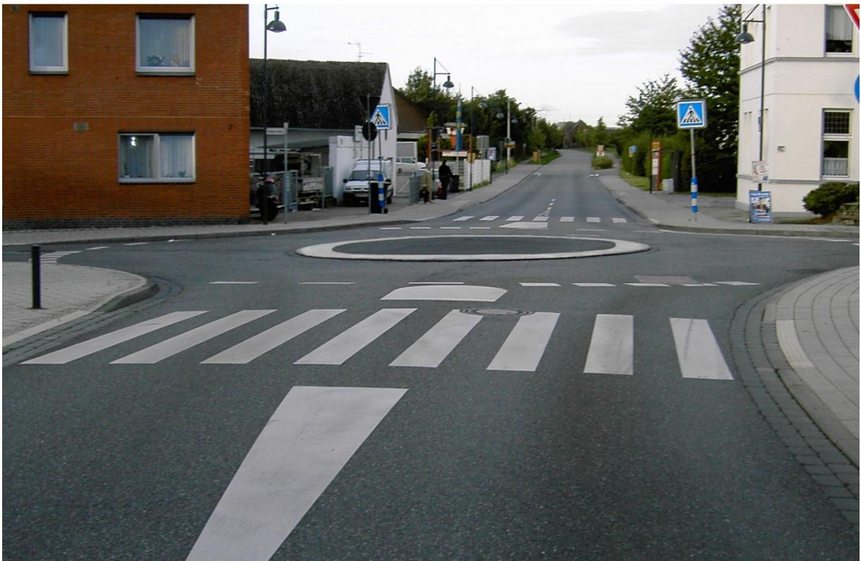
Abb. 8: Markierter Fahrbahnteiler
