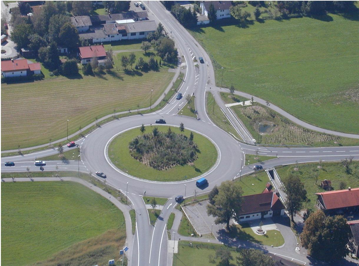
Abb. 2: Kleiner 2-streifig befahrbarer Kreisverkehr
