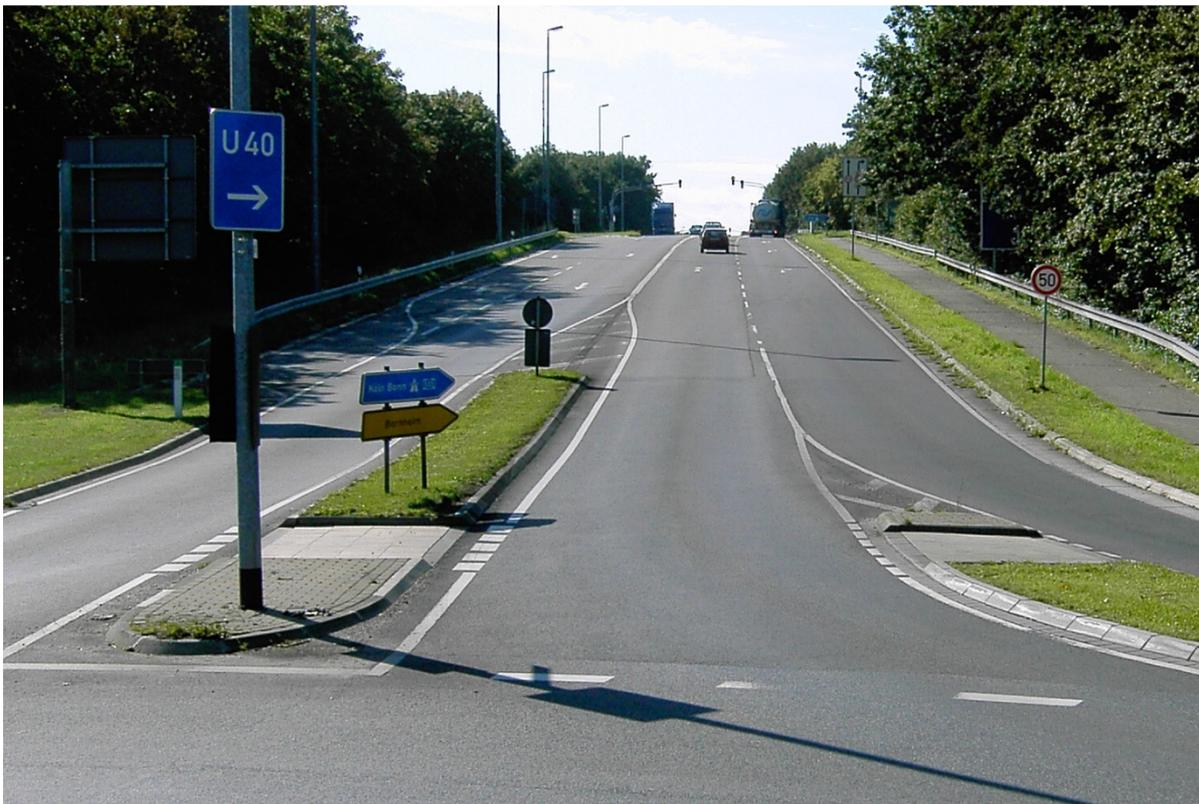
Abb. 19: Pfeilwegweiser in der Ausfahrt (hinter der Überquerungsstelle)
