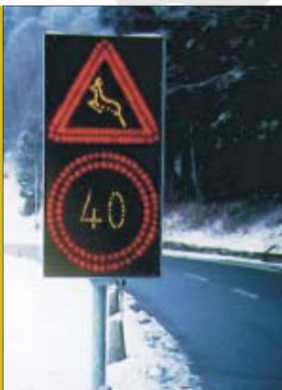
Elektronische Wildwechsel-Warnanlage, die sich nur bei Annäherung von Wild einschaltet.
