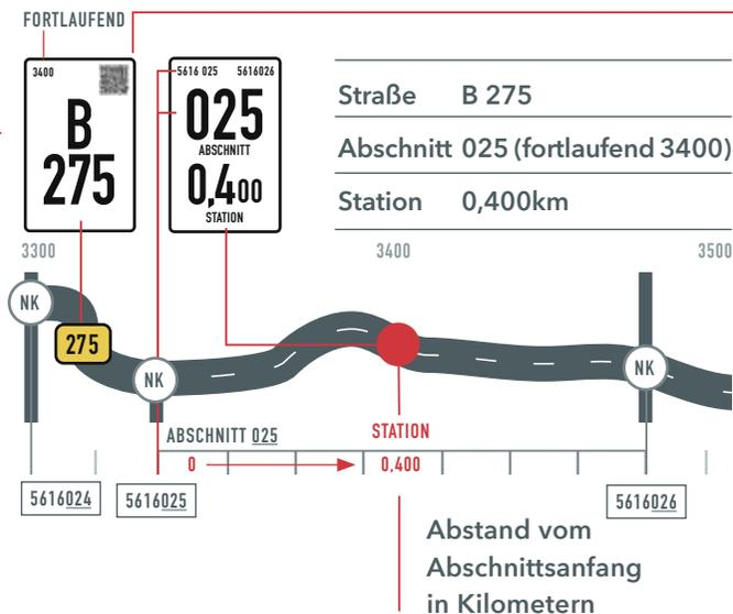
Jeder Abschnitt zwischen zwei Netznoten beginnt bei Null und endet mit der Gesamtlänge des Abschnitts. Eine Station gibt an, wie weit ein Standpunkt vom Anfang des Abschnitts entfernt liegt.
