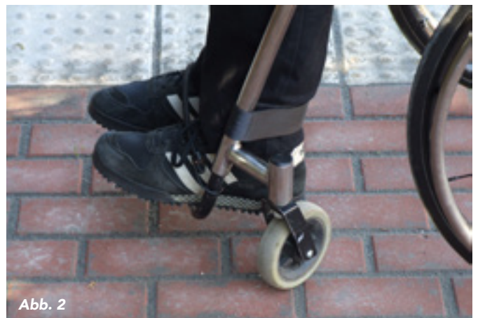
Abb. 1 und 2: Je nach Zweck und Antrieb haben Rollstühle unterschiedliche Räder, die unterschiedlich empfindlich auf Unebenheiten des Bodenbelags reagieren.
