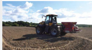
Abbildung 46: Ausbringung des Druschguts mit speziellem Tellerstreuer
