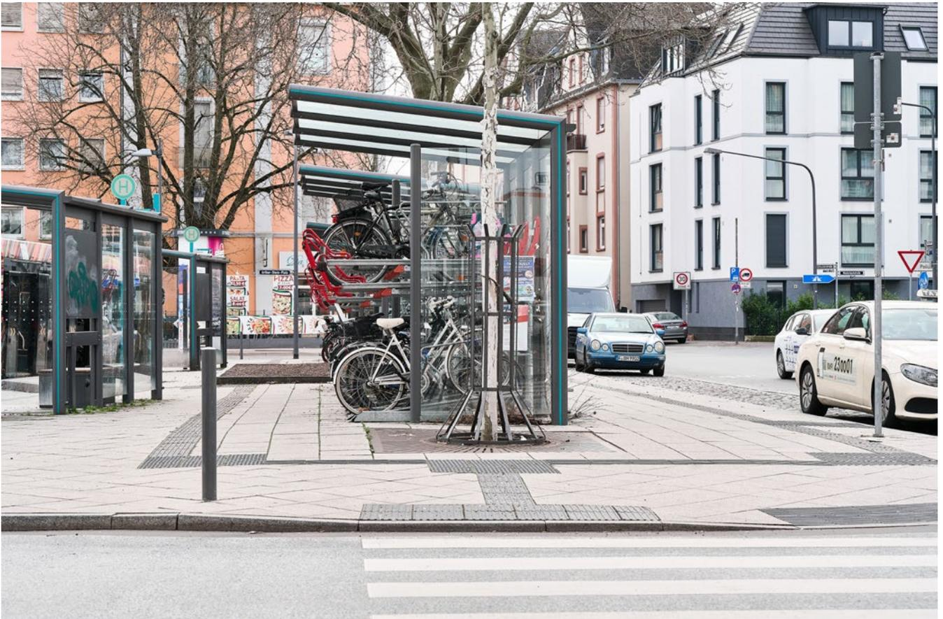
**Abb. 11:** Mit taktilen Bodenindikatoren gekennzeichnete Doppelstockanlage.
