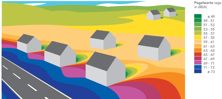
Bild 1 zeigt die Ausbreitung des Schalls einer Straße mit angrenzenden Wohnhäusern. An den Farben der Pegel ist zu erkennen, dass an den Gebäuden Pegelwerte von 71 bis 73 dB(A) erreicht und damit die Grenzwerte überschritten werden.
