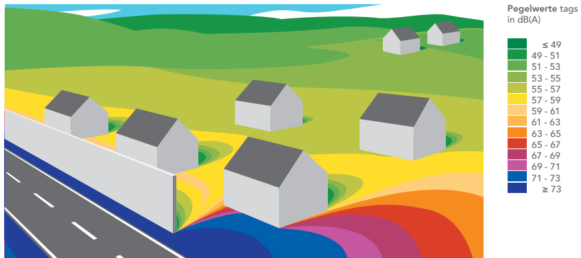
Bild 2 zeigt, dass Lärmschutzwand zwischen Straße und Wohnhäusern die Ausbreitung des Schalls begrenzt. An den Gebäuden hinter der Lärmschutzwand haben sich die Pegelwerte auf 57 bis 59 dB(A) reduziert und liegen damit unterhalb der Grenzwerte.
